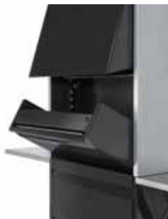
Al cerrar el cajón, la campana también se cierra, y la ceniza cae al cajón de recogida de cenizas.
